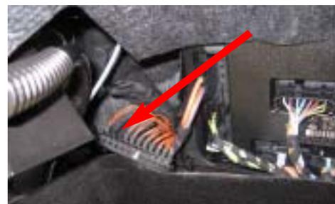
**N.B. Eseguire questa connessione solo con batteria vettura scollegata. Una errata connessione di questi cavi, può compromettere il funzionamento della vettura.**
